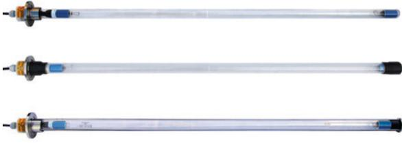
El UV-Set PURION 90W consiste en un tubo protector de cuarzo que se coloca en una brida de acero inoxidable con la lámpara UV PURION, la caja electrónica y cables de conexión.
